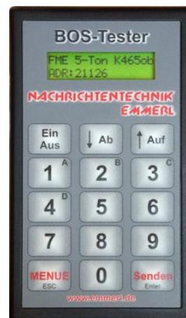
Der BOS-Tester ist ein Meldeempfängerprüfgerät, mit dem sowohl analoge Meldeempfänger als auch digitale Meldeempfänger ausgelöst werden können. Im Grunde handelt es sich um zwei Geräte, die in einem Gehäuse zusammengefasst sind. Deshalb finden Sie in dieser Bedienungsanleitung jeweils extra einen Abschnitt für die beiden Alarmierungsarten. Die Reichweite des BOS-Testers beträgt ca. einen Meter.
